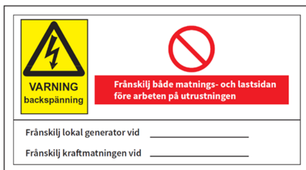
Varningsskylt för nätsidan, exempel
